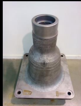
Exemple de pièce réalisée en WAAM
