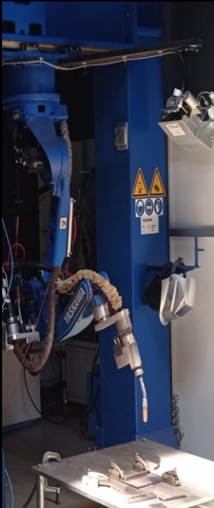
Equipements utilisés : Cellule robotisée Yaskawa et générateur type CMT
