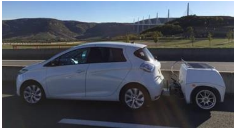
Figure 1 : Exemple de batterie sur remorque : EP-Tender 1
